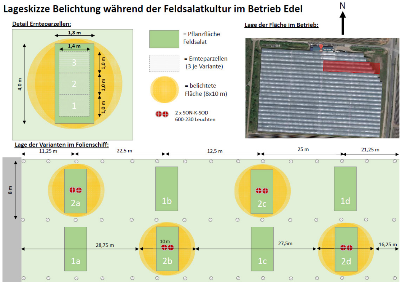
Abbildung 10: Parzellenverteilung des Belichtungsversuchs im Folienschiff des Betriebs Gemüsering Südhessen (Edel) mit je vier unbelichteten Parzellen (1 a-d) und vier Parzellen, die mit zwei SON-K-SOD Leuchten belichtet wurden (2 a-d); Lageskizze im Betrieb sowie Detail der Ernteparzellen.
